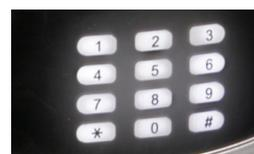
Clavier rétroéclairé par leds blanches.
