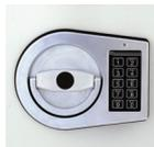
Serrure électronique norme Européenne ENV 1300 classe 2 VDS. 1 000 000 de combinaisons, 1 code maître et 1 code utilisateur programmables. Alimentation par pile de 9 volts accessible sous le clavier.
