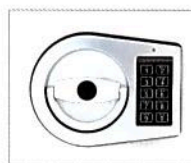
Serrure électronique norme Européenne ENV 1300 classe 2 VDS. 1 000 000 de combinaisons, 1 code maître et 1 code utilisateur programmables. Alimentation par pile de 9 volts accessible sous le clavier.
